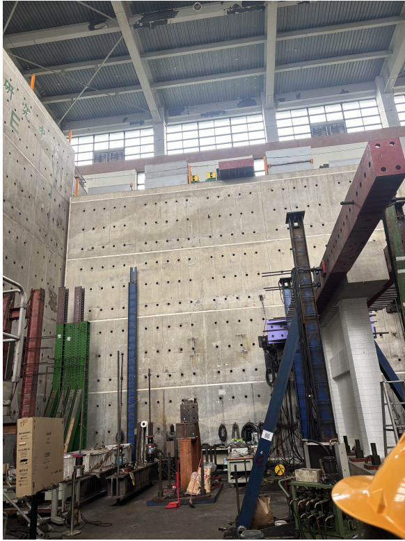
(a) 一樓反力牆實驗設施
