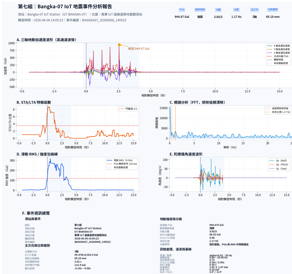
Figure 8: IoT 地震儀完整儀表板報告——包含高通濾波後三軸波形、STA/LTA 特徵函數、頻譜分析 (FFT)、滑動 RMS、陀螺儀角速度波形與事件資訊總覽。
